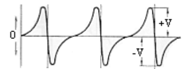
Señal eléctrica de salida del generador de impulsos
